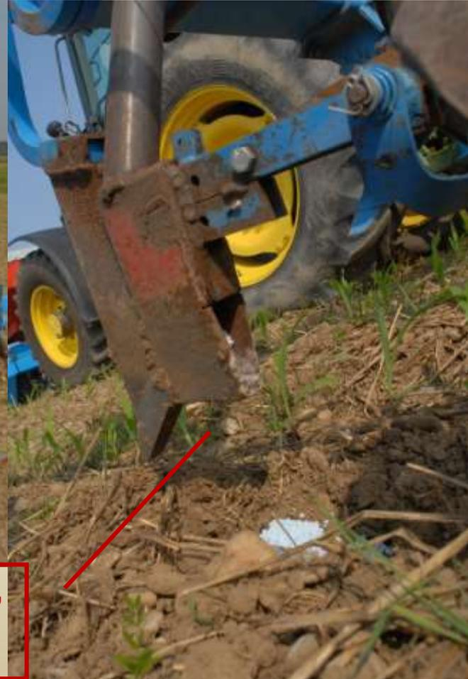
**Ex. Soc injecteur large avec fort ameublissement du sol, faible profondeur d'injection (env. 5 cm), fermeture partielle du sillon**
