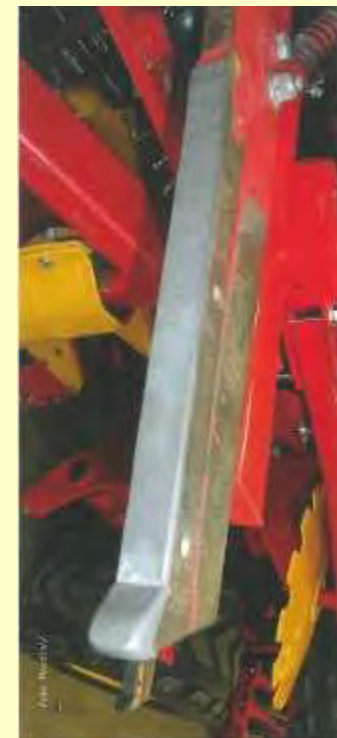
Schmalere Lockerungsschlitze, nur 25mm breit und hartmetallbeschichtet.
