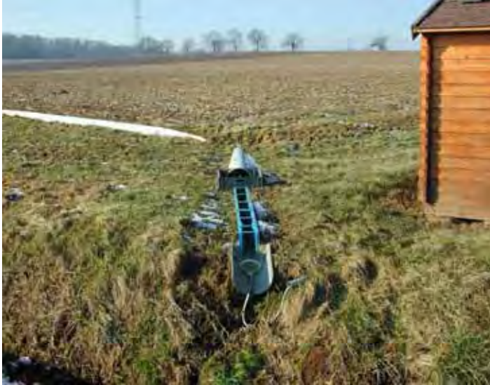
Sammelsystem für Oberflächenabfluss und System Venturi
