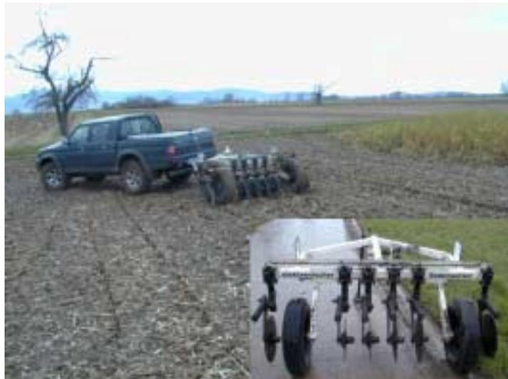
Abb. 9: GPS-gestützte Messung der elektrischen Bodenleitfähigkeit mit dem ‚Veris 3100‘ im März 2001 in der KSZ Weisweil.
