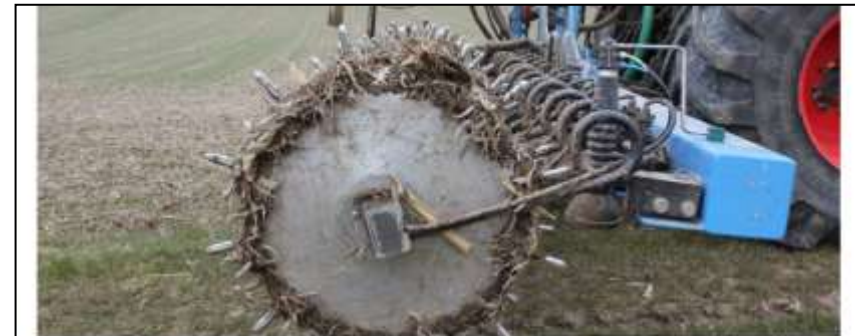
Abb. 7: Ausbringung von flüssigem Stickstoff-Dünger mittels Stornradtechnik zu Winterweizen im Frühjahr Foto: Thomas Würfel/ITZ
